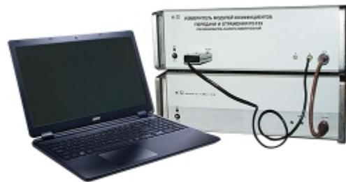
Прибор обладает широкими возможностями для исследований и измерений. Благодаря использованию прибора с компьютером, процесс измерений полностью автоматизирован. Имеется возможность диалогового режима работы с прибором, что исключает ошибки вследствие неправильной работы оператора. Вывод информации осуществляется в цифровуквенной и графической форме на экране ЭВМ.
